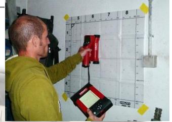
Recherche d'armatures par ferroskan
